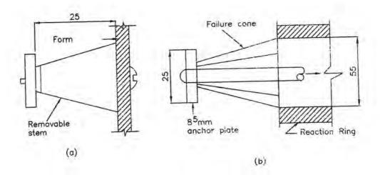
Fig. 3.4.1. LOK Test Assembly
