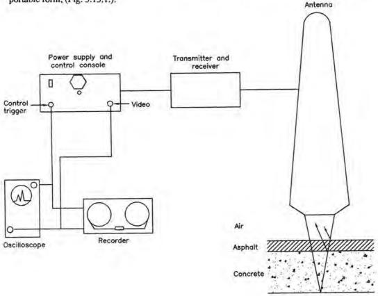
Fig. 3.13.1. Elements of a Radar System<sup>8</sup>
