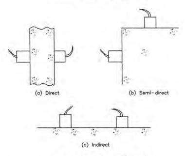
Fig. 3.8.1. Types of Reading<sup>8</sup>
