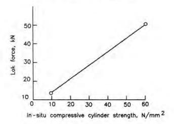
Fig. 3.4.2. Calibration Chart for LOK Test1
