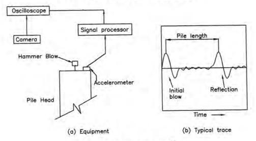
Fig. 3.10.3. Pulse Echo Method<sup>11</sup>
