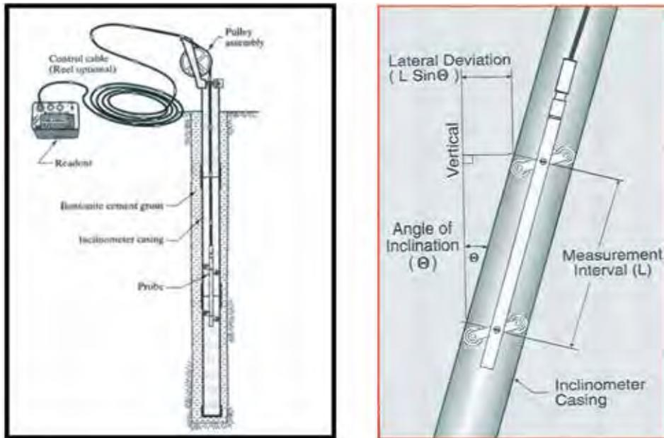
Fig. 6.8 Inclinometer
