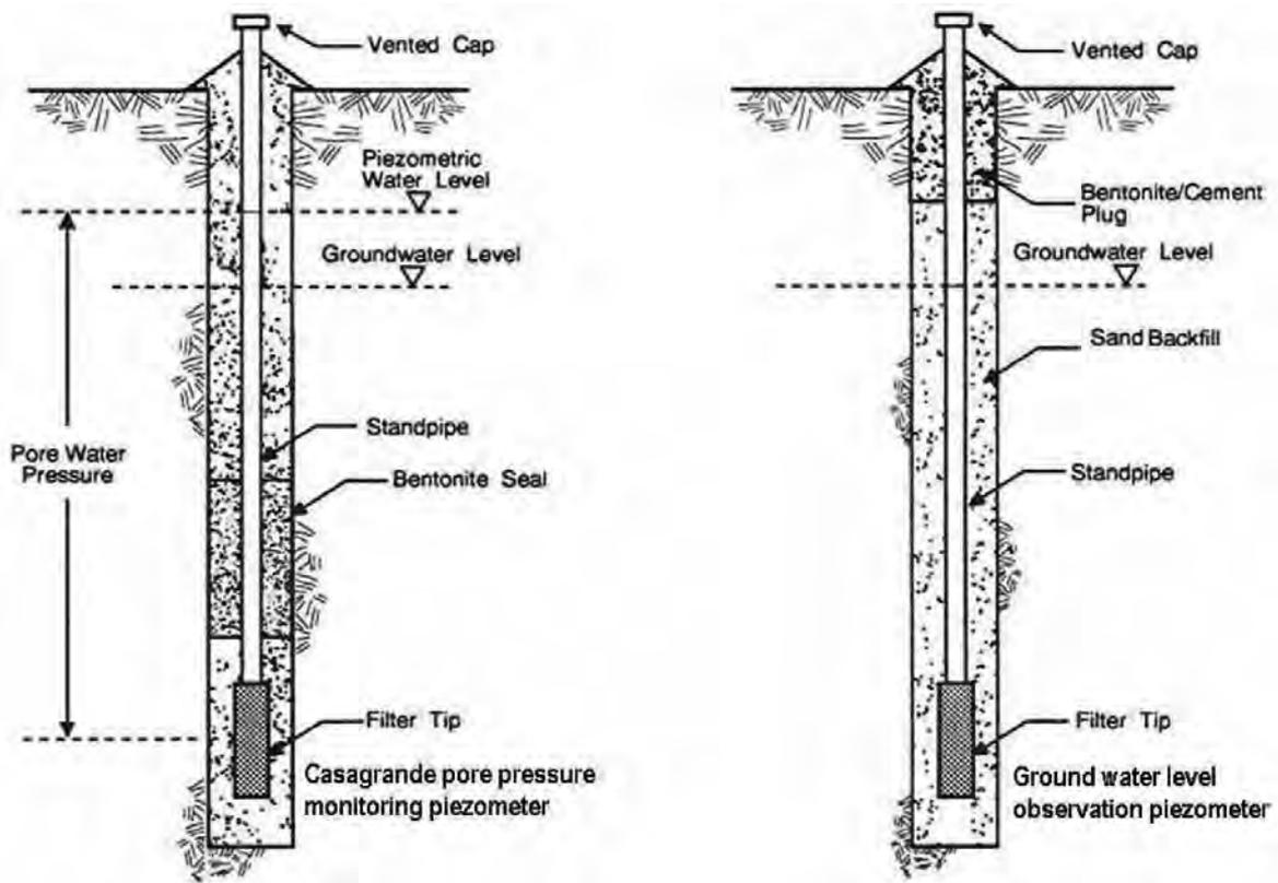
Fig. 6.2 Casagrande Piezometer
