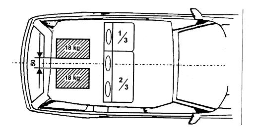
FIG 7 POSITION OF TEST BLOCKS BEFORE TEST OF REAR SEAT BACK (Para 5.9.3)
