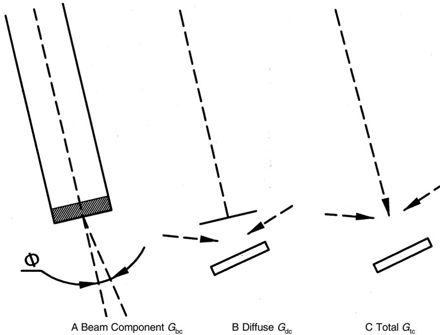
FIG. 2 COMPONENTS OF SOLAR RADIATION ON EARTH
