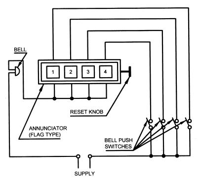
FIG. 1 SIMPLE ELECTRIC CALL BELL SYSTEM
