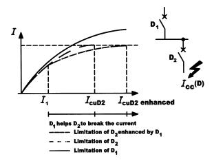
FIG. 12 LIMITATION CURVES FOR CIRCUIT-BREAKERS
