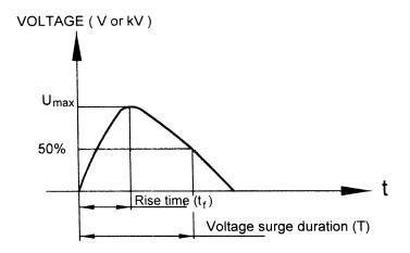
FIG. 2 TRANSIENT OVERVOLTAGE AT INDUSTRIAL FREQUENCY
