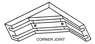
FIG. 18 SHAPE OF JOINT AT A CORNER
