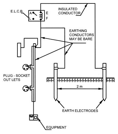
FIG. 9 CONNECTION OF EARTH LEAKAGE CIRCUIT-BREAKER SIMPLE INSTALLATION
