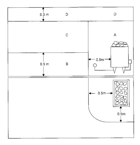
FIG. 3 CLASSIFICATION OF TEMPERATURE ZONES
