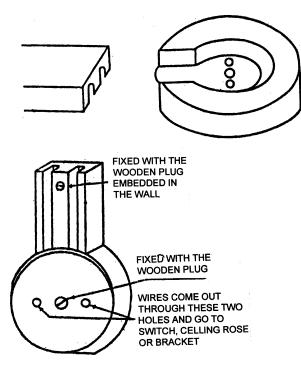
FIG. 15 JOINT FOR FIXING LAMP
