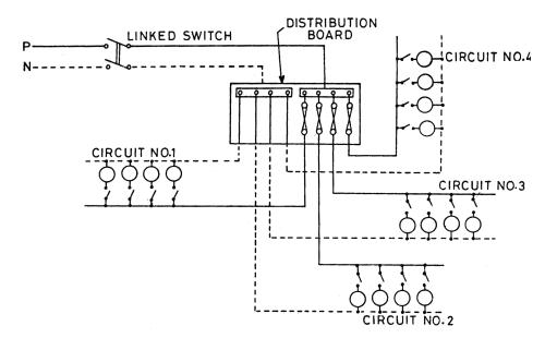
FIG. 1 A TYPICAL DISTRIBUTION BOARD SYSTEM
