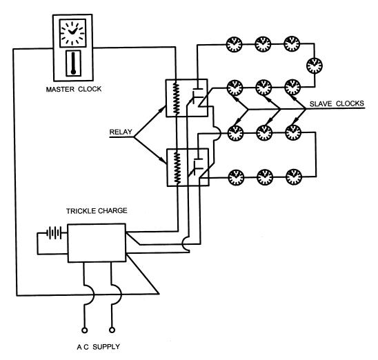
FIG. 3 IMPULSE MASTER CLOCK SYSTEM
