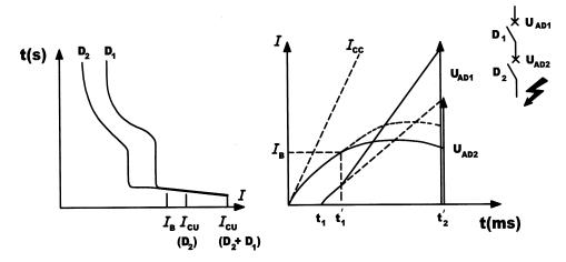
FIG. 11 OPERATION OF CIRCUIT-BREAKERS IN CASCADE
