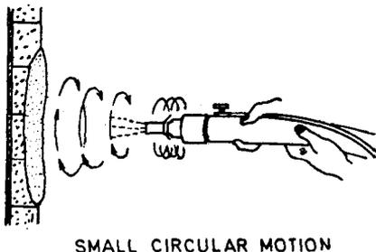
FIG. 6 METHOD OF SHOTCRETING OPERATION FOR MINIMUM REBOUND
