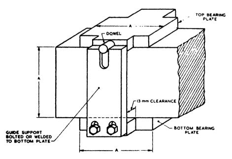
FIG 2 DEVICE FOR ALIGNING BLARING PLATES
