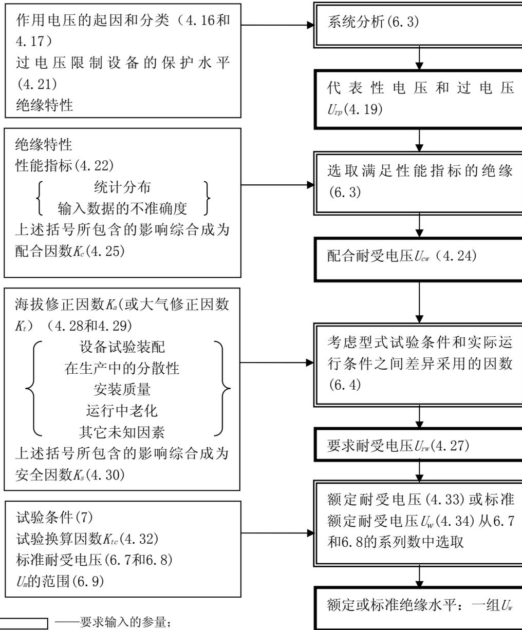
注1: 图中绝缘特性是指内绝缘、外绝缘、自恢复绝缘、非自恢复绝缘、相对地绝缘、相间绝缘、纵绝缘以及绝缘材料介质特性等。
