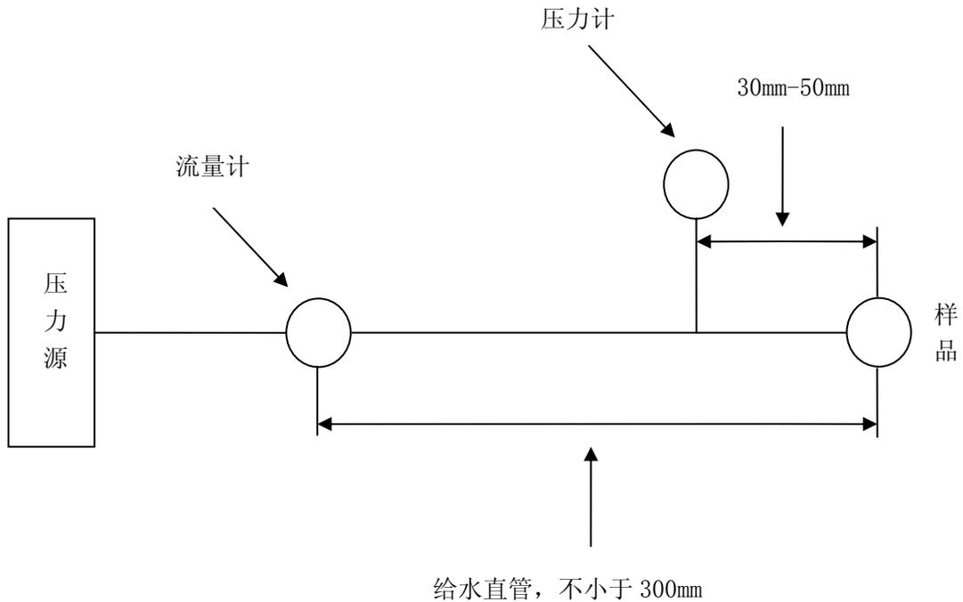
图 1 流量试验装置示例
