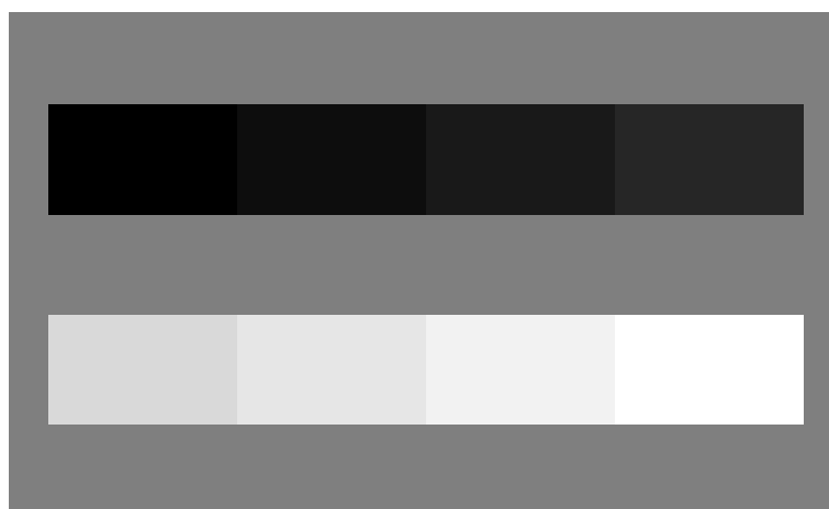
图 A.1 极限八灰度等级信号示意图
