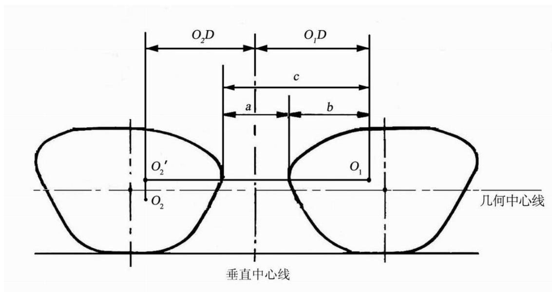
$O_2'O_1$ —光学中心水平距离
